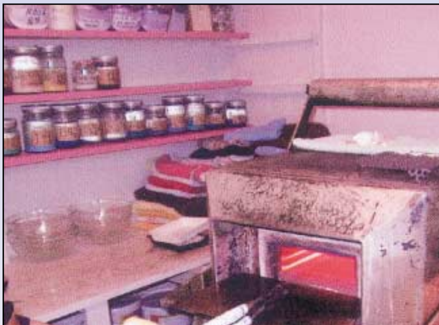
I ovnen er arbeidstemperaturen bortimot 900 grader.
